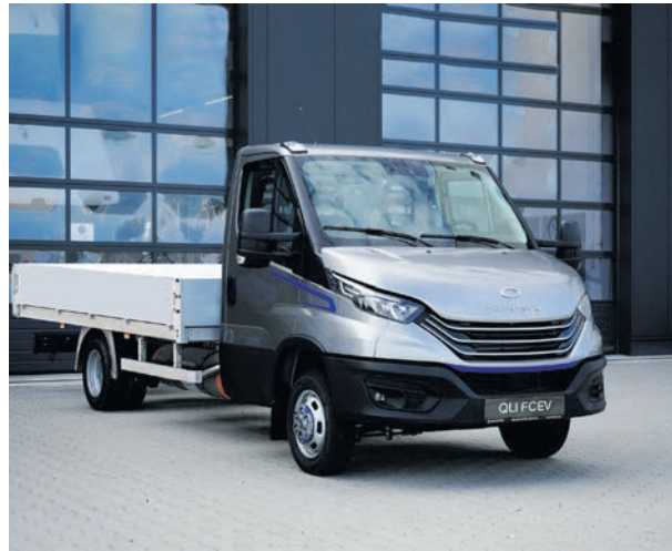
Das Grundgerüst des Fahrgestells der Firma Quantron verfügt über eine Reichweite von 300 bis 370 Kilometern und wiegt – ohne Aufbau – rund 2600 Kilogramm. FOTO: QUANTRON AG.
